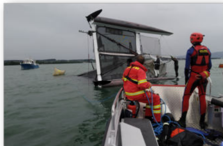
Wiederaufrichten eines durchge kenterten Katamarans mittels eines von Einsatztauchern in 18 m Tiefe am Mast angebrachten Hebekissens. Foto: FF Langenargen
